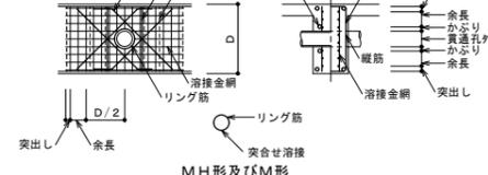
図9.2 補強筋の定着長さ
