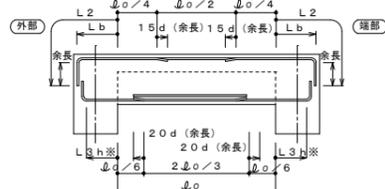
図5.12 小梁主筋の継手、定着及び余長(その2)
